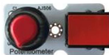
Ο αισθητήρας βασίζεται σε ένα ποτενσιόμετρο. Ένα ποτενσιόμετρο είναι επίσης γνωστό ως μεταβλητή αντίσταση. Βασίζεται στο κύκλωμα διαιρέτη μεταβλητής τάσης. Το αναλογικό σήμα που μας δίνει είναι μια μεταβλητή τάση, που μπορεί να υποδιαιρεθεί από 0 έως 1023. Μπορεί να χρησιμοποιηθεί ως μεταβλητό αναλογικό σήμα, γωνιόμετρο και γενικά μπορεί να προσομοιώσει μεταβλητά αναλογικά σήματα για τις δραστηριότητες των μαθημάτων και, σε συνδυασμό με άλλους αισθητήρες, μπορείτε να κάνετε ενδιαφέροντα έργα.
