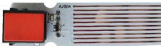
Αυτός ο αισθητήρας είναι εύκολος στη χρήση και ειδικά σχεδιασμένος για να αναγνωρίζει και να ανιχνεύει τη στάθμη του νερού. Αυτός ο αισθητήρας είναι μικρός και εξοπλισμένος με τα ακόλουθα χαρακτηριστικά:
