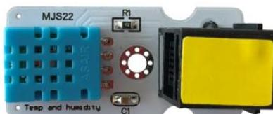
Η μονάδα αισθητήρα θερμοκρασίας και υγρασίας είναι ένας ψηφιακός αισθητήρας μέτρησης θερμοκρασίας και υγρασίας του περιβάλλοντος χώρου. Χρησιμοποιεί έναν χωρητικό αισθητήρα υγρασίας και ένα θερμίστορ (θερμοαντίσταση), για τη μέτρηση των συνθηκών του περιβάλλοντος αέρα και παρέχει έξοδο ψηφιακού σήματος.
