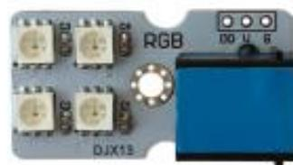
Η συσκευή RGB LED είναι μια πηγή φωτός 4 RGB LEDs που ενσωματώνει το κύκλωμα ελέγχου και το κύκλωμα φωτισμού. Το LED χρησιμοποιούν χαμηλή τάση, υψηλή φωτεινότητα, ευρεία γωνία σκέδασης, καλή συνοχή, εξαιρετικά χαμηλή ισχύ και έχουν μεγάλη διάρκεια ζωής, Μπορείτε εύκολα να το συνδέσετε στον ελεγκτή ARD:icon χρησιμοποιώντας ένα καλώδιο RJ11.
