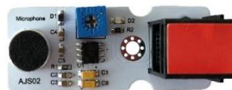
Συσκευή Αναλογικής Εισόδου Αυτός ο αισθητήρας ήχου χρησιμοποιείται συνήθως για την ανίχνευση της έντασης ήχου στο περιβάλλον. Οι αισθητήρες ήχου παράγουν αναλογικά σήματα, δηλαδή η τιμή του ηλεκτρικού σήματος ποικίλει ανάλογα με την ένταση ή την πίεση του ήχου. Αυτά τα αναλογικά σήματα μπορούν να αναπαρασταθούν ως αναλογική τάση ή αναλογική ένταση ρεύματος. Μπορείτε να το χρησιμοποιήσετε για να δημιουργήσετε διαδραστικά κυκλώματα, όπως να προγραμματίσετε έναν διακόπτη φωνητικού ελέγχου.
