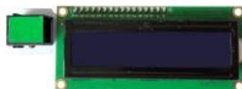
Η συσκευή αυτή είναι μια οθόνη LCD 16 χαρακτήρων και 2 γραμμών με λευκό κείμενο σε μπλε φόντο. Στο πίσω μέρος διαθέτει ένα ποτενσιόμετρο για τη ρύθμιση της αντίθεσης της οθόνης.
