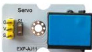
Η συσκευή αυτή είναι συσκευή διασύνδεσης – επέκτασης του σετ. Χρησιμοποιείται για τη σύνδεση διάφορων συσκευών, όπως ο σερβοκινητήρας και το laser. Ουσιαστικά μετατρέπει τη σύνδεση της συσκευής από τρισύρματη σε RJ11, και με αυτό το τρόπο μπορεί εύκολα να συνδεθεί στον ελεγκτή ARD:icon με καλώδιο τύπου UTP. Επίσης, σε συνδυασμό με πλακέτα ανάπτυξης κυκλωμάτων (breadboard), μπορείτε να συνδέσετε ηλεκτρονικά στοιχεία με τον ελεγκτή ARD:icon.
