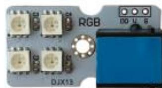
Η συσκευή RGB LED είναι μια πηγή φωτός 4 RGB LEDs που ενσωματώνει το κύκλωμα ελέγχου και το κύκλωμα φωτισμού. Το LED χρησιμοποιούν χαμηλή τάση, υψηλή φωτεινότητα, ευρεία γωνία σκέδασης, καλή συνοχή, εξαιρετικά χαμηλή ισχύ και έχουν μεγάλη διάρκεια ζωής. Μπορείτε εύκολα να το συνδέσετε στον ελεγκτή ARD:icon χρησιμοποιώντας ένα καλώδιο RJ11.
