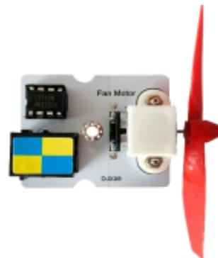
Με αυτή τη μονάδα μικρού ηλεκτρικού μοτέρ με ανεμιστήρα μπορείτε να φτιάξετε ένα σκάφος με έλικα, ένα σύστημα ψύξης ή μια μηχανή περιστροφής. Μπορεί εύκολα να σβήσετε τη φωτιά ενός αναπτήρα σε απόσταση 20 εκατοστών, αλλά και να ελέγχετε την ταχύτητα περιστροφής του έλικα, αν συνδεθεί σε συγκεκριμένες θύρες του ελεγκτή (D3/D5/D6/D9).
