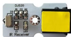
Ο δέκτης υπέρυθρων είναι ένα στοιχείο με λειτουργίες λήψης, διαμόρφωσης και αποδιαμόρφωσης σήματος και παράγει απευθείας ψηφιακό σήμα. Θα είναι επίσης εύκολο να φτιάξετε τον δικό σας ελεγκτή υπερύθρων, χρησιμοποιώντας τον πομπό υπερύθρων και να δημιουργήσετε έναν διακόπτη υπέρυθρων ακτίνων, ή να στείλετε σήματα από τον πομπό στο δέκτη.
