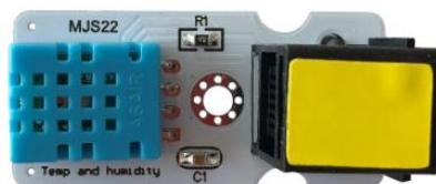
Η μονάδα αισθητήρα θερμοκρασίας και υγρασίας είναι ένας ψηφιακός αισθητήρας μέτρησης θερμοκρασίας και υγρασίας του περιβάλλοντος χώρου. Χρησιμοποιεί έναν χωρητικό αισθητήρα υγρασίας και ένα θερμόστορ (θερμοαντίσταση), για τη μέτρηση των συνθηκών του περιβάλλοντος αέρα και παρέχει έξοδο ψηφιακού σήματος.
